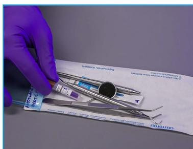
**6** Terminado o ciclo de esterilização, aguarde 15 minutos para o resfriamento. Abra o envelope e recupere a ampola teste autoclavada. Verifique o resultado do indicador químico tipo 5. Se aprovado, prossiga para o passo 7. Se reprovado, identifique o motivo da reprovação e se não encontrar ligue para o CRC ou assistência técnica autorizada. Interdite o equipamento até resolver a situação e só utilize após a aprovação do teste químico tipo 5 e do indicador biológico.
