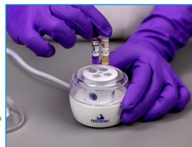
**11** Para indicadores de 24 horas, faça a leitura inicial com 8 horas, depois com 12 horas e a final com 24 horas. Para indicadores de 48 horas, faça leituras intermediárias com 24, 36 e a final com 48 horas. Atenção: **Caso a ampola teste apresente a cor amarela em algum momento, interdiça a autoclave** e recolha todos os pacotes esterilizados desde o último teste biológico aprovado. Só volte a utilizá-la após solucionar o motivo da reprovação.
