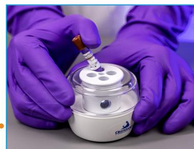
**7** Introduza 1/3 da ampola teste dentro da incubadora. Para ativá-la dobre a parte superior da ampola plástica, que é flexível. Isso resultará na quebra da ampola interna de vidro, liberando o meio de cultura para contato com os esporos. Cuidado para não romper a parte plástica.
