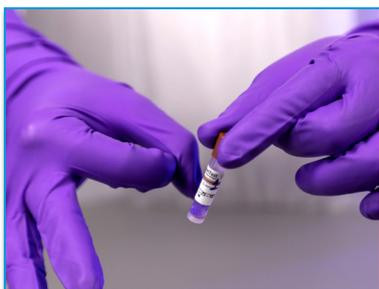
**8** Segure a ampola conforme demonstrado. Dê um peteleco na parte inferior do tubo. Certifique-se de que o meio de cultura roxo embebeu totalmente o disco com esporos. A parte superior da ampola possui um filtro hidrofóbico (veja a foto detalhada da ampola na página 2) que não deve ser molhado, por esse motivo, não agite a ampola de cima para baixo.
