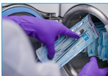
**3** Coloque um indicador biológico (ampola teste) em um envelope dentro da autoclave já abastecida com um ciclo padrão\*. Inclua um indicador químico tipo 5 SteamPlus no pacote da ampola teste.
